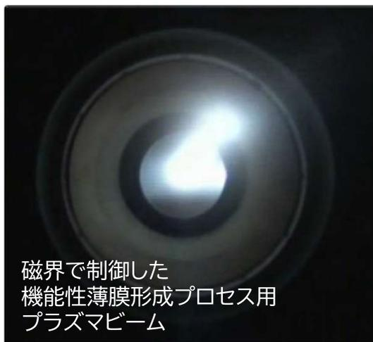
磁界で制御した機能性薄膜形成プロセス用プラズマビーム
