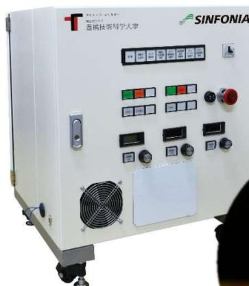
放電プラズマを用いて、水中に植物の栄養となる窒化物イオンを製造
