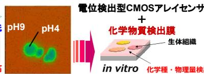
電位検出型CMOSアレイセンサ + 化学物質検出膜 + 生体組織
