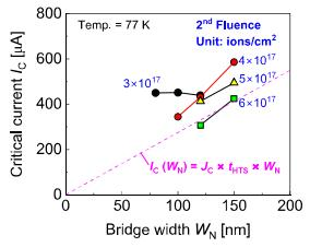
加速電圧40 kV、照射量 $4 \times 10^{17} - 6 \times 10^{17}$  ions/cm<sup>2</sup>のGa-FIB照射で作製したナノブリッジの臨界電流は、照射量とブリッジ幅に対して直線的な依存性を示した。Ga-FIB照射によって、EIIIRIS 2F測定室のNB5000 (Hitachi High-tech, NB5000)を使用した。
