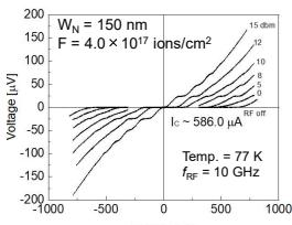
Ga-FIB照射で作製したナノブリッジは、マイクロ波照射によりV-I特性に理論値に一致する電圧ステップ(シャビロステップ)を示した。これにより、ナノブリッジがジョセフソン接合として動作していることを確認した。
