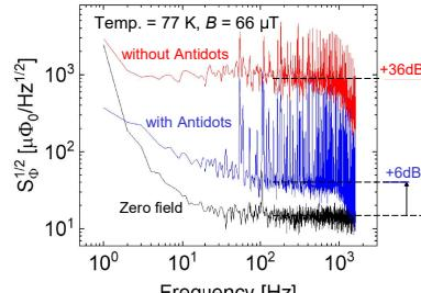
アンチドットを導入していないSQUIDでは、地磁気程度の磁場66 μTの印可によって、1 – 1000 Hzでノイズが増加した。一方で、アンチドットを導入したSQUIDでは、ノイズが1/60に抑制された。
