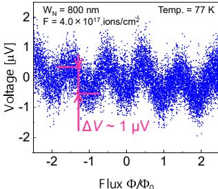
ナノブリッジ型SQUIDに対して磁場を印可すると、サイン波状の周期的な電圧波形が得られた。この結果から、ナノブリッジ型SQUIDがDC-SQUIDとして動作していることを確認した。
