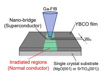
Ga-FIB照射によって高温超伝導薄膜をナノメートルレベルの狭窄部を残して常伝導化することで、超伝導ナノブリッジを作製する。
