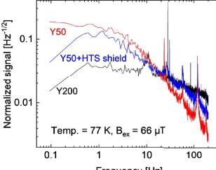
YBCO 200 nmのSQUIDと比較し、極薄膜SQUID (YBCO 50 nm)ではノイズが増加した。一方で、超伝導薄膜シールドを貼り付けたSQUIDでは、10 Hz以下のノイズが抑制された。
