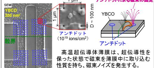
高温超伝導体薄膜は、超伝導性を保った状態で磁束を薄膜中に取り込む性質を持ち、磁束ノイズを発生する。そこで、磁束を固定(ピン止め)する機能を有するアンチドット(超伝導性を示さない穴)を、FIB照射によって粒界の近傍に形成した。
