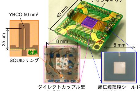
ノイズ增加の原因となる磁束の侵入を防ぐため、極薄膜SQUID (YBCO 50 nm)に超伝導薄膜シールド (YBCO 200 nm)を貼り付けた。
