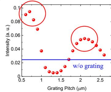
For Pitch = 0.7 μm (2.1 μm): x4 (x2.5)
